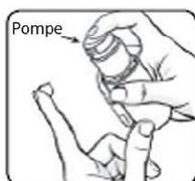
Pour fermer la pompe, remettez le bouchon. Enfoncez le bouchon et faites-le tourner dans le sens des aiguilles d'une montre (vers la droite) jusqu'à ce qu'il se bloque. La pompe est de nouveau munie d'une sécurité enfants.
